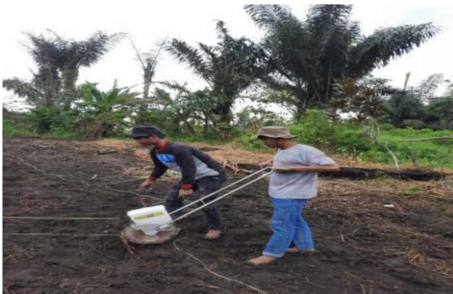
Gambar 1. Penanaman Benih Padi Gogo Menggunakan Alat yang Dapat Mengurangi Tenaga Kerja. Jarak Tanam dan Jumlah Benih Per Lubang Tanam Diatur pada Alat (Purba, 2022).
