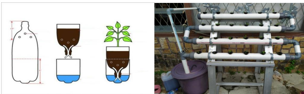
Gambar 3. Cara Kerja Sistem Sumbu dan Instalasi Sayuran Hidroponik
