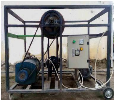
Gambar Mesin Pembangkit Listrik
