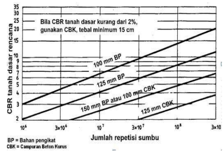
Gambar 3 Tebal pondasi bawah minimum untuk perkerasan beton semen (Pd T-14-2003).
